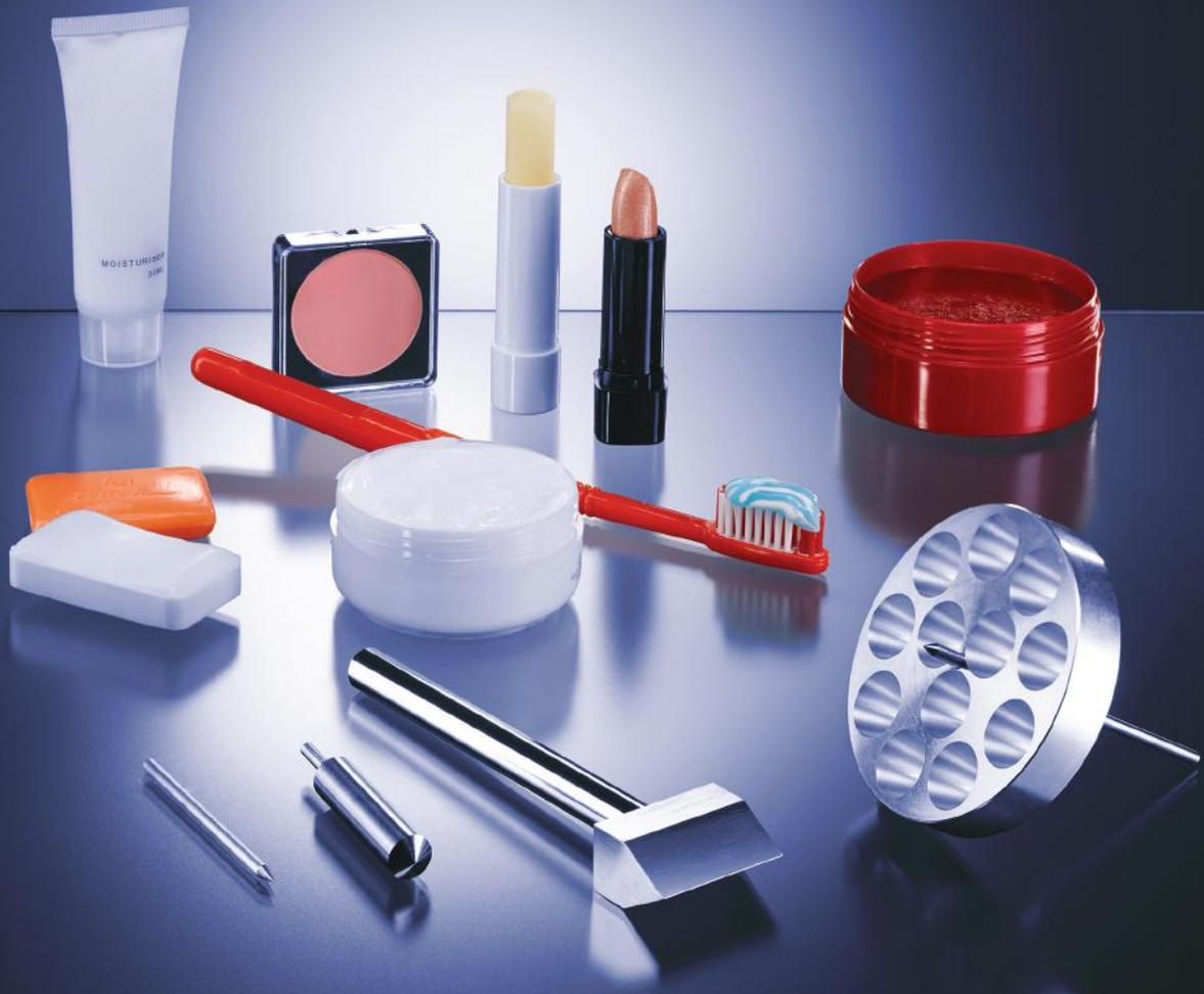
El penetrómetro PNR 12 mide la resistencia de un material a ser perforado por un cuerpo de prueba con forma específica. Es usado para determinar la consistencia y plasticidad de muestras pastosas, cremosas, semisólidas o muy viscosas.
