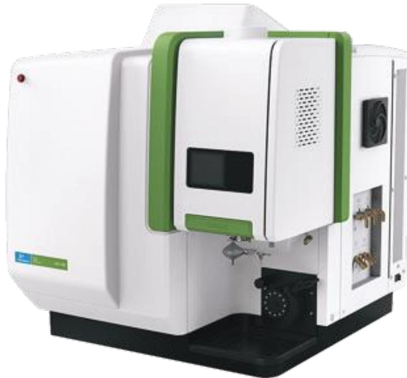
El nuevo ICP-OES Avio 500 de PerkinElmer es un instrumento completamente simultáneo, con vista dual del plasma y diseño compacto. Su sensibilidad y resolución superiores lo convierten en el instrumento ideal para su laboratorio, garantizando el mejor desempeño y el uso eficiente de sus recursos, incluso con las muestras más problemáticas.
