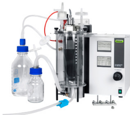
Figura 3: . La configuración estándar del Encapsulador B-395 de BUCHI con recipiente de reacción de vidrio en su lugar.
