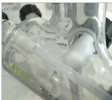
Se detecta automáticamente la formación de espuma y se suprime la misma al pulsar brevemente el botón de ventilación. El detector de espuma es compatible con los módulos de vidrio descendentes.
