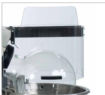
Pantalla de protección específica para realizar baños calefactores, combinada con una rejilla de protección que asegura la máxima seguridad durante la operación.
