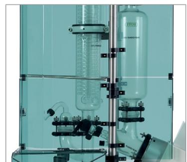
Plástico PMMA robusto y transparente para proteger los módulos de vidrio del Rotavapor® R-220 Pro de cualquier daño potencial que puedan causar influencias externas.
